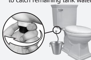
**Retirez l'écrou de montage. Utilisez une clé, au besoin.**
