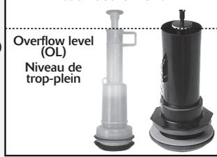
**Placez la soupape dans le réservoir. Poussez la soupape vers le bas jusqu'à ce que le niveau d'eau de la soupape de remplissage se trouve à environ 12,7 mm sous l'extrémité supérieure du niveau de trop-plein de la soupape de chasse.**
